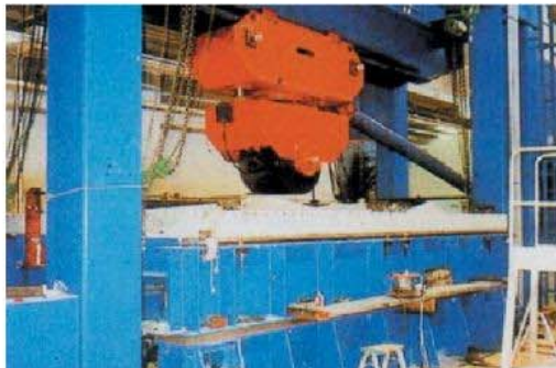
旧建設省土木研究所(現)土木研究センター、民間15社による共同研究「道路橋床版の輪荷重走行試験における疲労耐久性評価手法の開発」(平成11年10月)より
