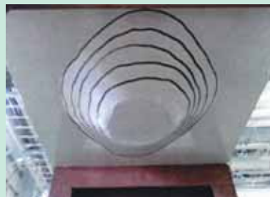
アロンブルコート®Z-X工法の押し抜き試験結果
